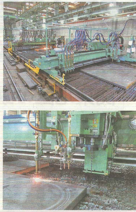
水素切断用NCガス溶断機が並ぶ（手前が新設した「KT-650G」）。先穴あけ用ドリル装置付き（写真右）
